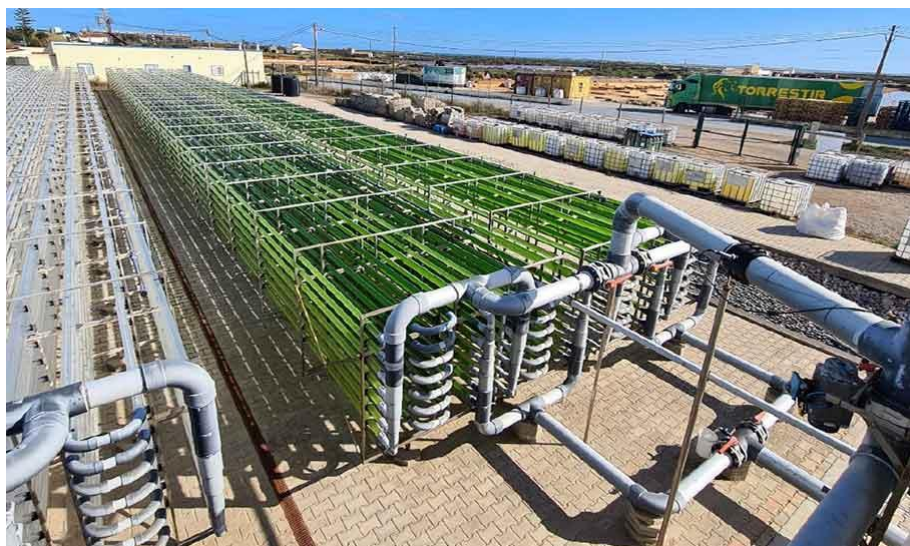
Рисунок 4 – Трубчатый фотобиореактор объемом 19 м 3 для очистки дренажных вод и производства биомассы микроводорослей в рамках проекта AlgaCycle
